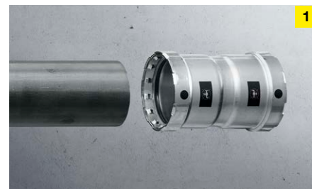
Ocelová trubka se zkrátí a vyčistí. Potom se vyměří a označí hloubka zasunutí. Nakonec se na trubku až ke značce nasune spojka Megapress.
