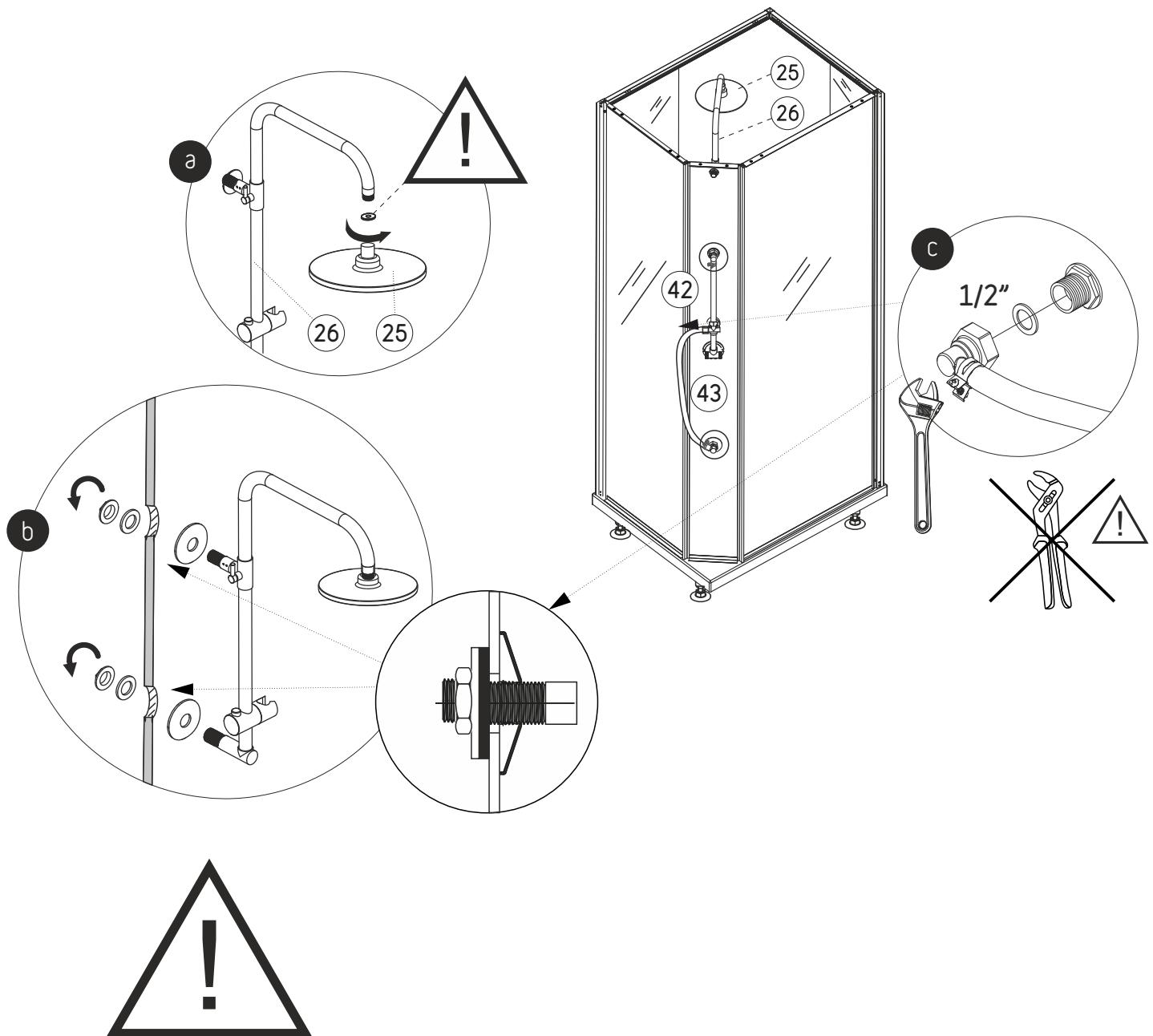
**S** Montera inte blandare och skruvar utan gummi-pakningar och brickor mellan glaset och blandaren/skruvarna. Spänn ej skruvarna för hårt. Härdat glas kan explodera i tusentals bitar, om riktlinjerna inte följs.
